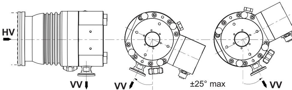
图片 5： 使用油封前级泵时的建议对准
