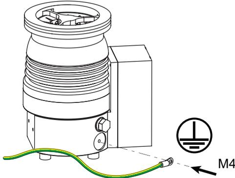
图片 13: 示例:连接接地电缆
