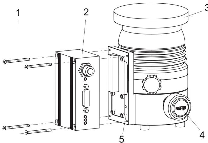
图片 17： 电子驱动单元的安装和拆卸
