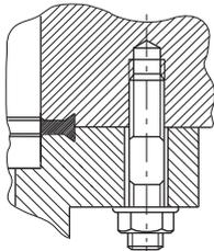
图片 9: CF-F 法兰连接, 螺杆和螺纹孔
