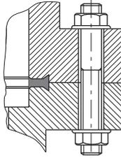
图片 10: CF-F 法兰连接, 螺杆和通孔
