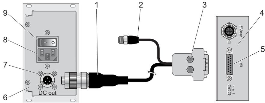
图片 14： 将电子驱动单元连接到电源包上
