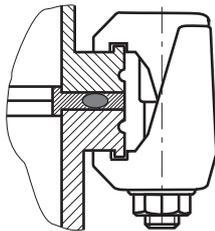
图片 7： ISO-K 至 ISO-F 的法兰连接, 支架螺钉
