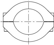
图片 6: ISO-KF 至 ISO-KF 法兰连接
