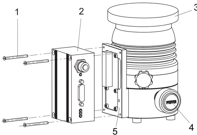
图片 17： 电子驱动单元的安装和拆卸
