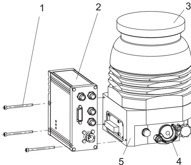
**Abb. 20: Demontage der Antriebselektronik TC 400**
