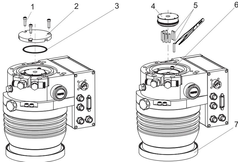
**Abb. 18: Betriebsmittelspeicher demontieren**
