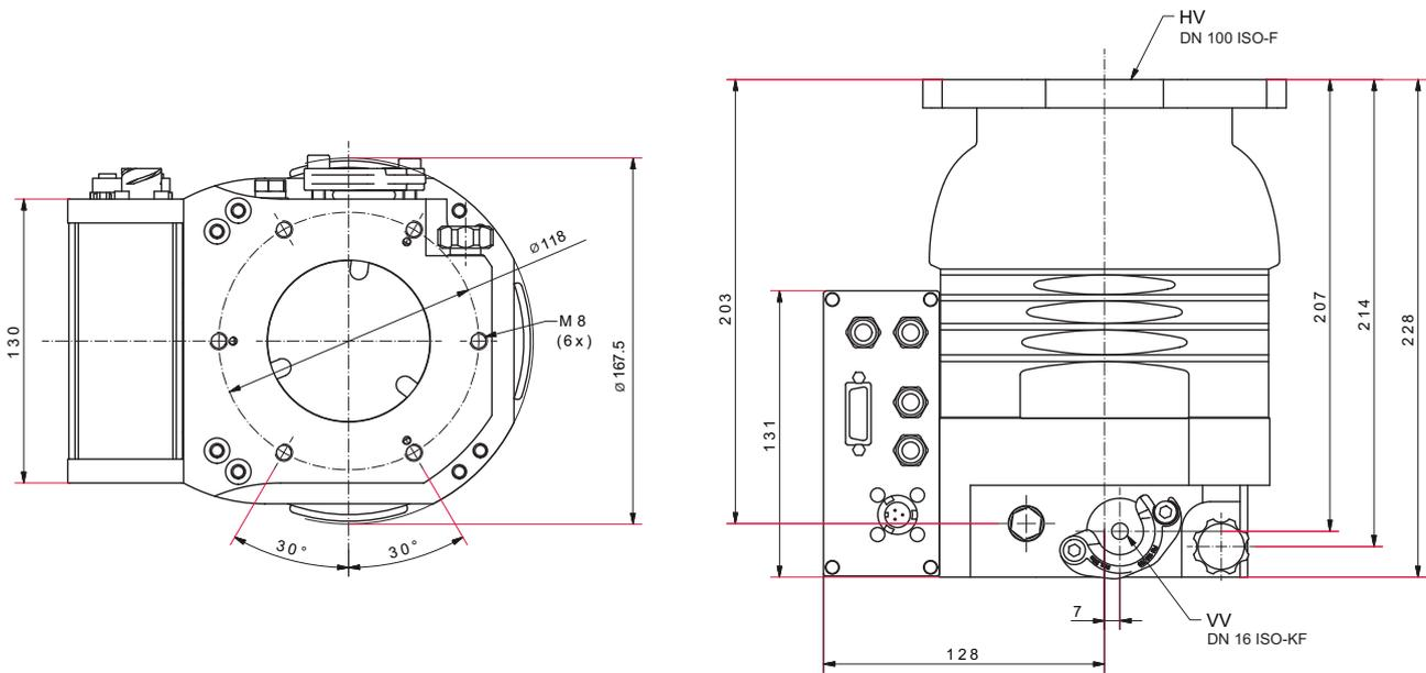
Abb. 25: Abmessungen HiPace 350 | TC 400 | DN 100 ISO-F
