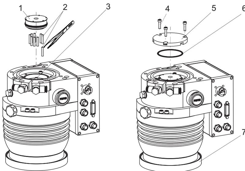
**Abb. 19: Betriebsmittelspeicher montieren**
