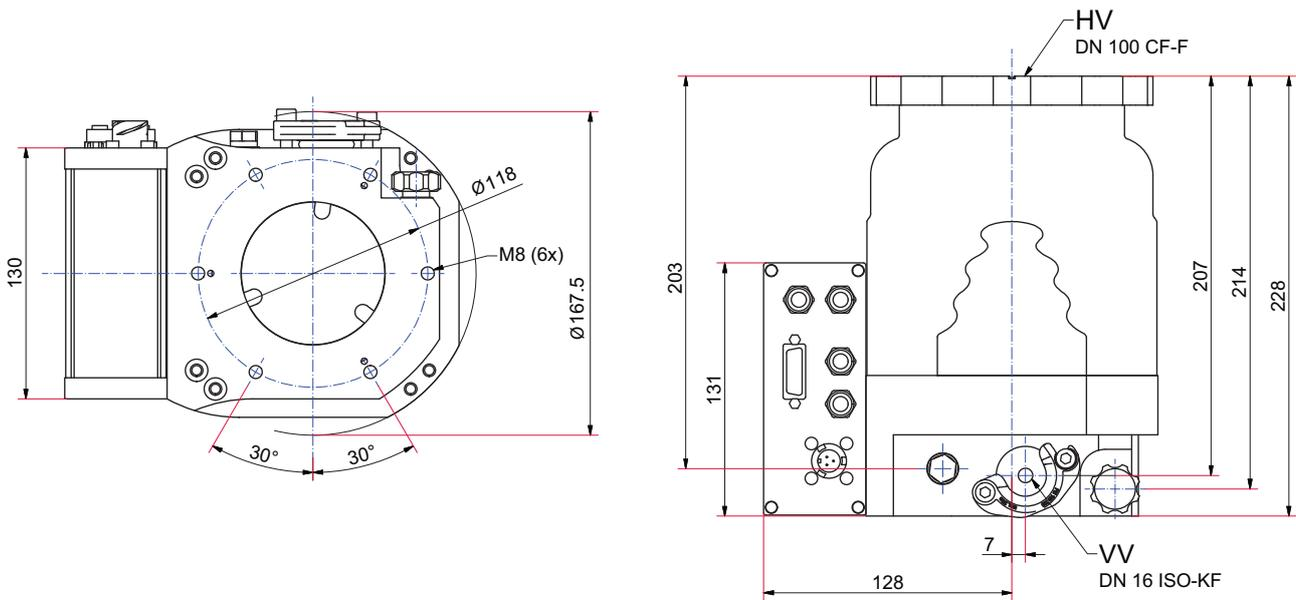
Abb. 26: Abmessungen HiPace 350 | TC 400 | DN 100 CF-F
