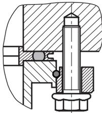
Abb. 6: Flanschverbindung ISO-K zu ISO-F, Sechskantschraube und Gewindebohrung
