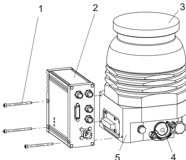
**Abb. 21: Montage der Antriebselektronik TC 400**
