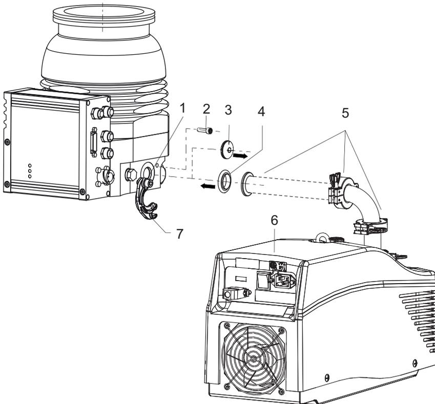
**Abb. 15: Beispiel für den Vorvakuumanschluss**
