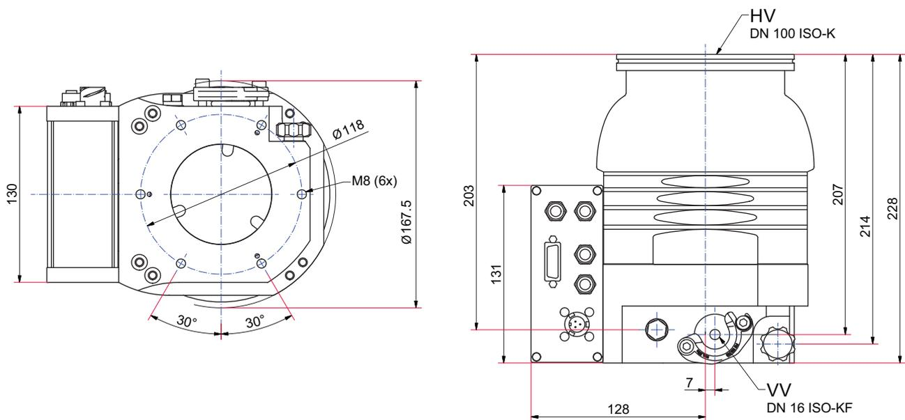
Abb. 24: Abmessungen HiPace 350 | TC 400 | DN 100 ISO-K
