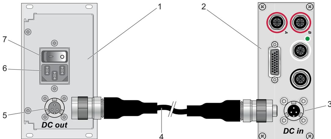
**Abb. 17: Antriebselektronik mit Netzteil verbinden**
