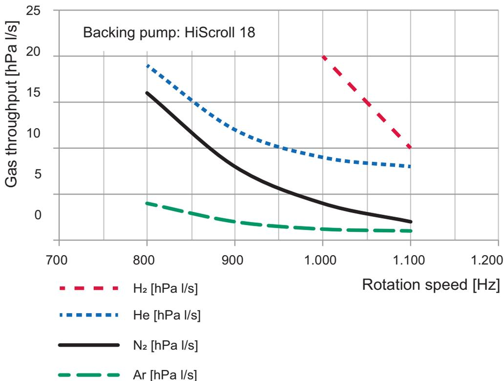
Abb. 23: Kennlinie Gasdurchsatz in Abhängigkeit der Drehzahl
