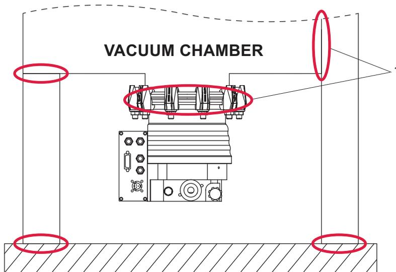
Abb. 3: Beispiel: Sicherung gegen Verschieben und Kippen durch externe Erschütterungen
