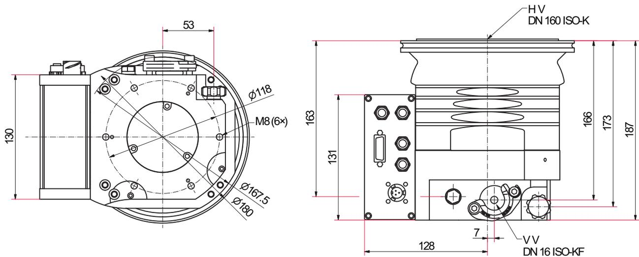
Abb. 24: Abmessungen HiPace 450 | TC 400 | DN 160 ISO-K
