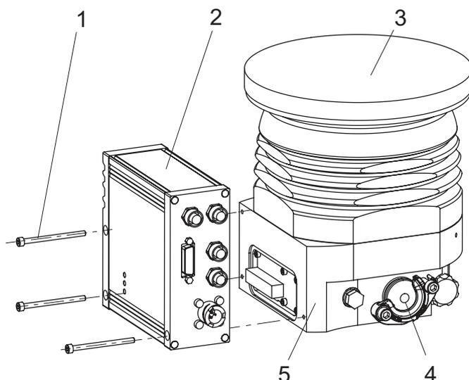
**Abb. 21: Montage der Antriebselektronik TC 400**
