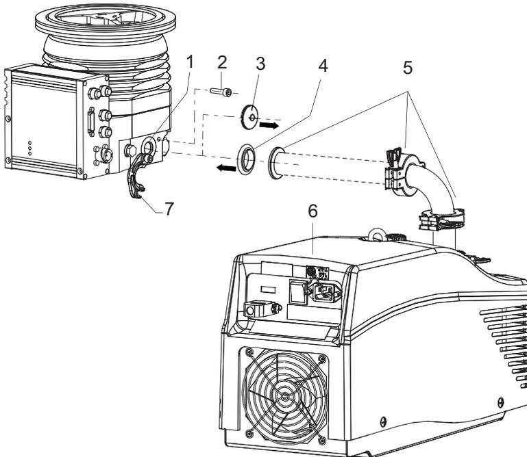
**Abb. 15: Beispiel für den Vorvakuumanschluss an HiPace 450**
