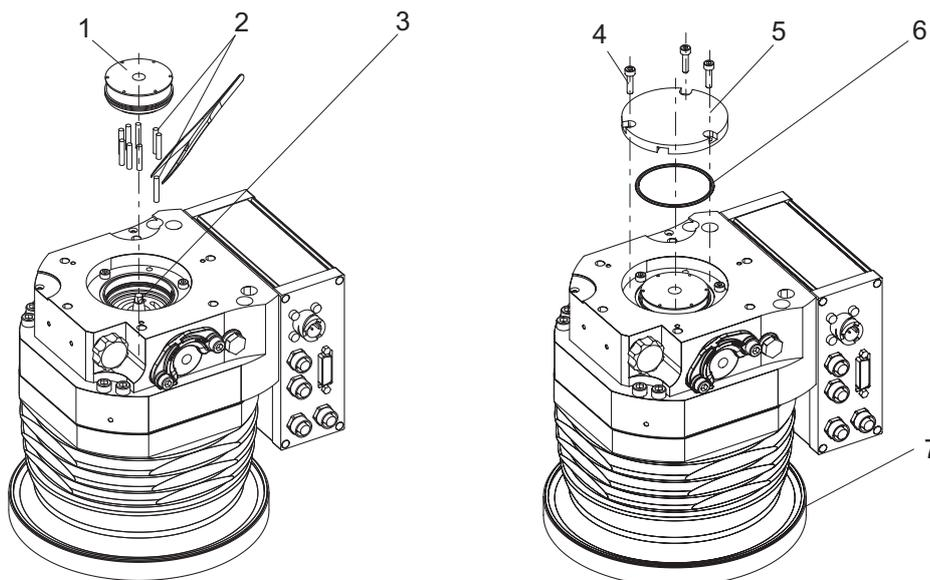
**Abb. 19: Betriebsmittelspeicher montieren**
