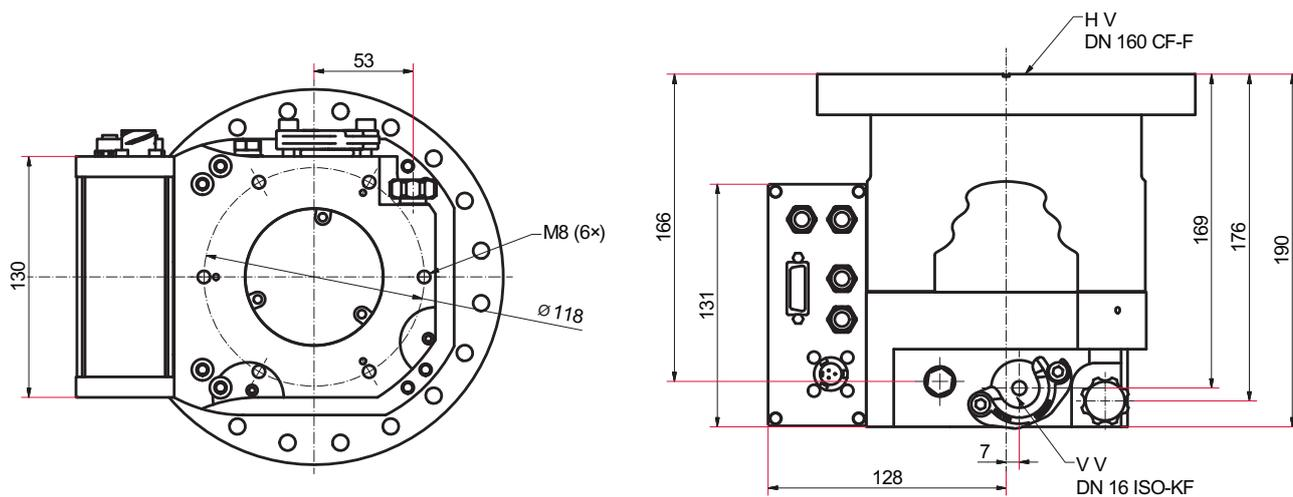
Abb. 26: Abmessungen HiPace 450 | TC 400 | DN 160 CF-F
