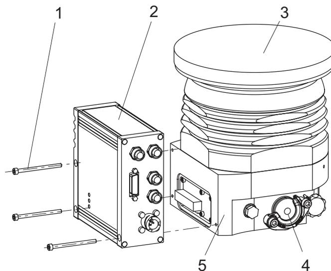
Abb. 20: Demontage der Antriebselektronik TC 400
