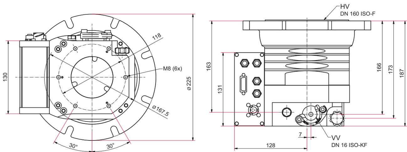
Abb. 25: Abmessungen HiPace 450 | TC 400 | DN 160 ISO-F
