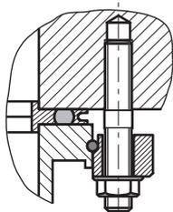
**Abb. 7: Flanschverbindung ISO-K zu ISO-F, Stiftschraube und Gewindebohrung**
