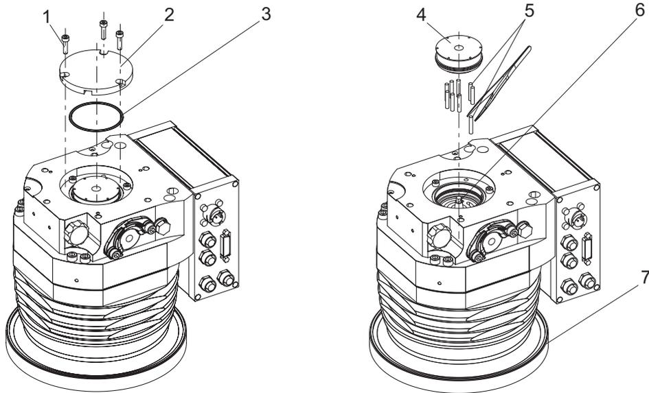
**Abb. 18: Betriebsmittelspeicher demontieren**
