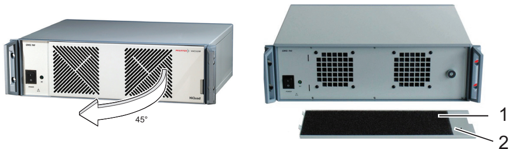
图片 50: 更换过滤垫
